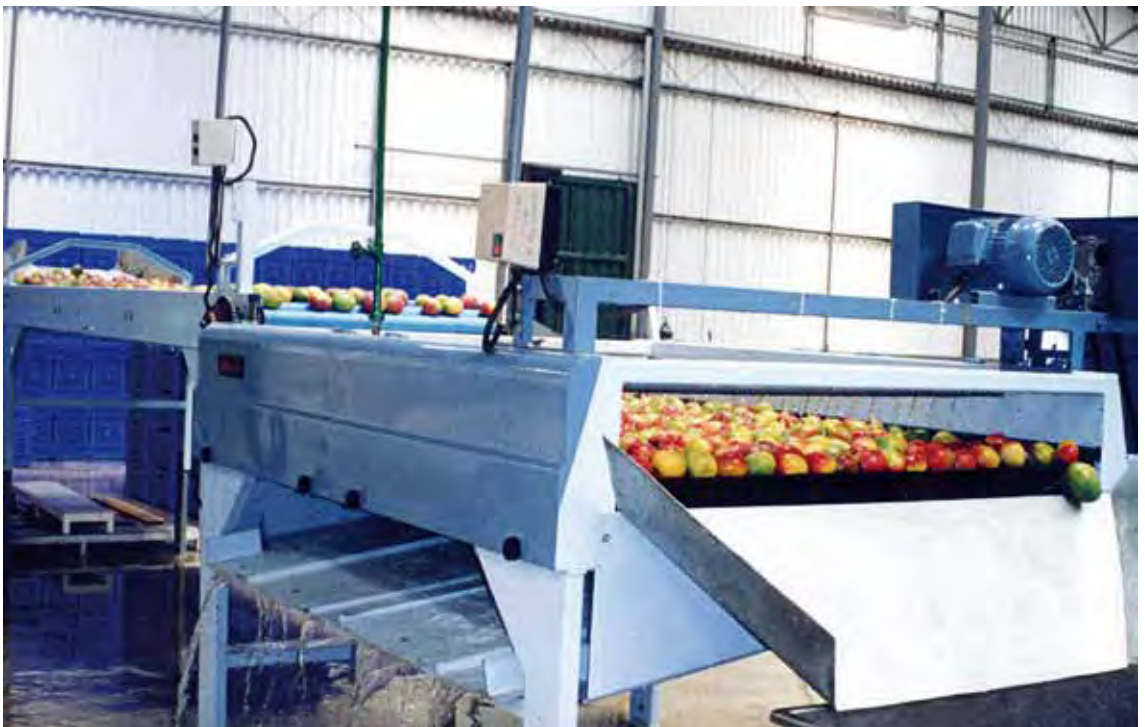
Máquina seleccionadora de frutas. Los socios de la cooperativa se ven beneficiados con este proceso porque les permite estandarizar sus productos y ofrecer los de mejor calidad.
